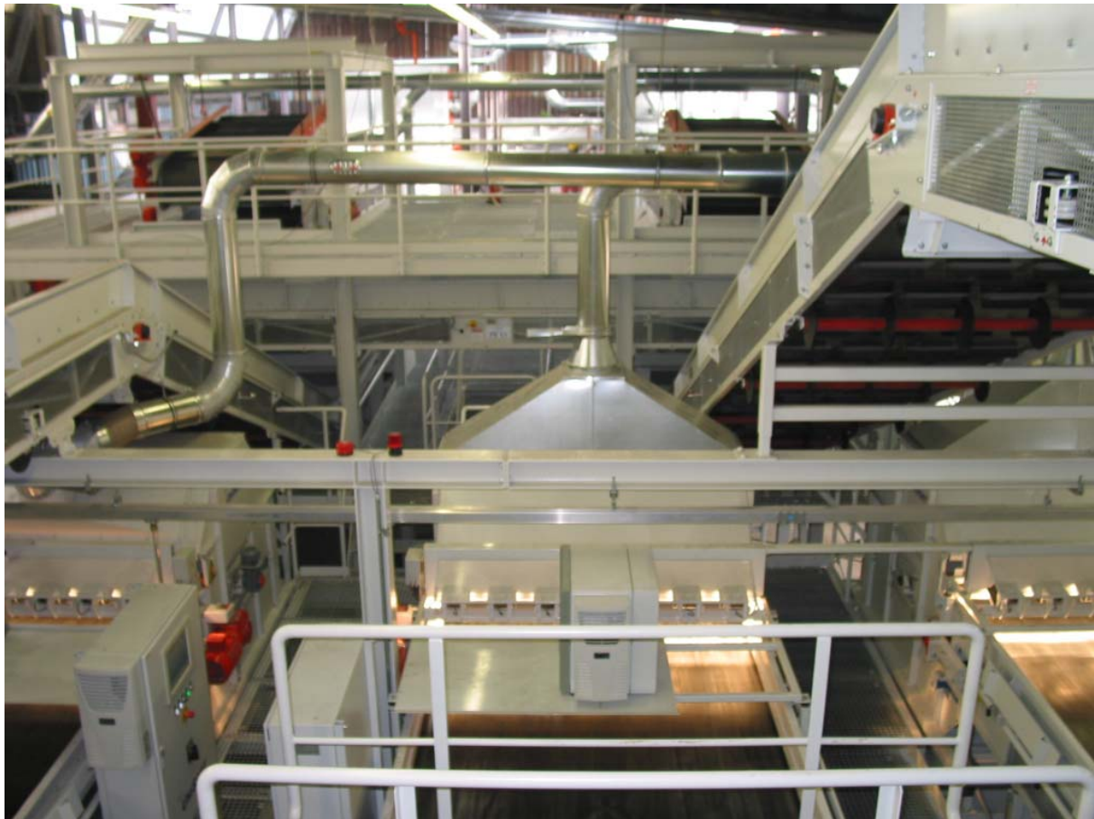
Abbildung 3 Maschinenhalle mit 3 der 4 NIR-Trennern
